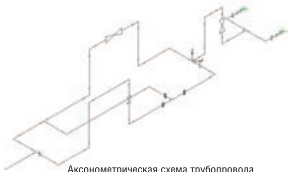
Аксонометрическая схема трубопровода в системе КОМПАС,
