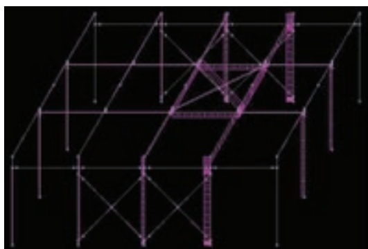
Эпюры усилий в SCAD схемы металлоконструкций
